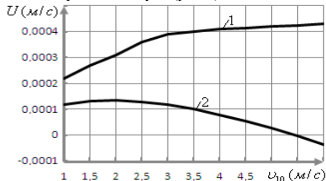
Рис.3. Зависимость U(v_{10}) при 65% H_2 в смеси: 1 –первый порядок реакции без учёта диффузии компонентов, 2 –первый порядок реакции с учётом диффузии компонентов.
