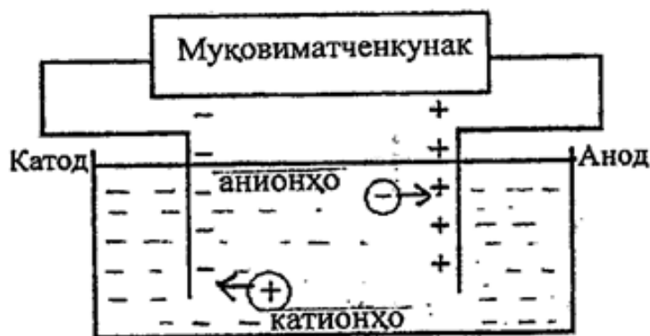
Расми 4. Самти ҳаракати анионҳо ва катионҳо дар маҳлул Рисунок 4. Направление движения анионов и катионов в растворе Figure 4. Direction of movement of anions and cations in solution
