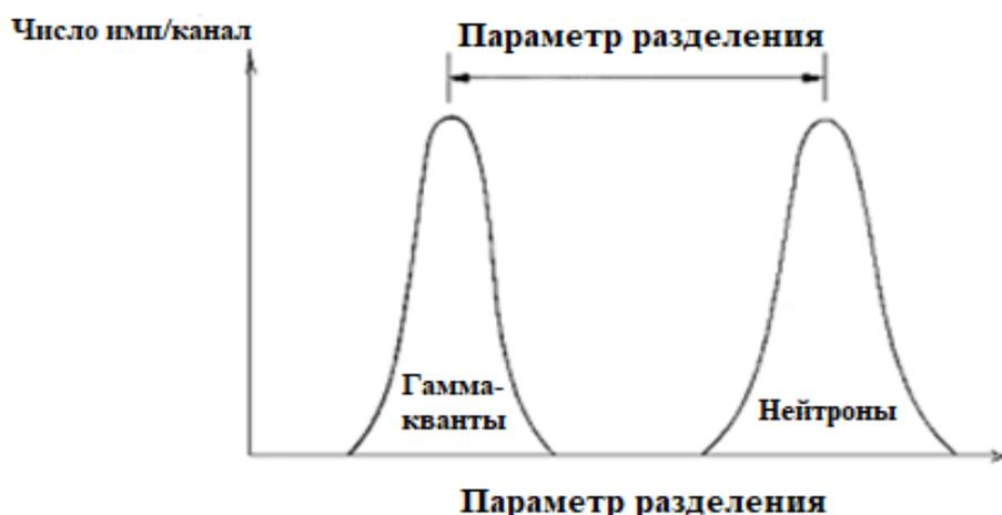
Для распознавания обнаруженных частиц для каждого импульса с помощью программы считался параметр разделения, который определяется отношением двух площадей конкретного участка импульса к его амплитуде ( $S_1$ ,  $S_2$ ).
